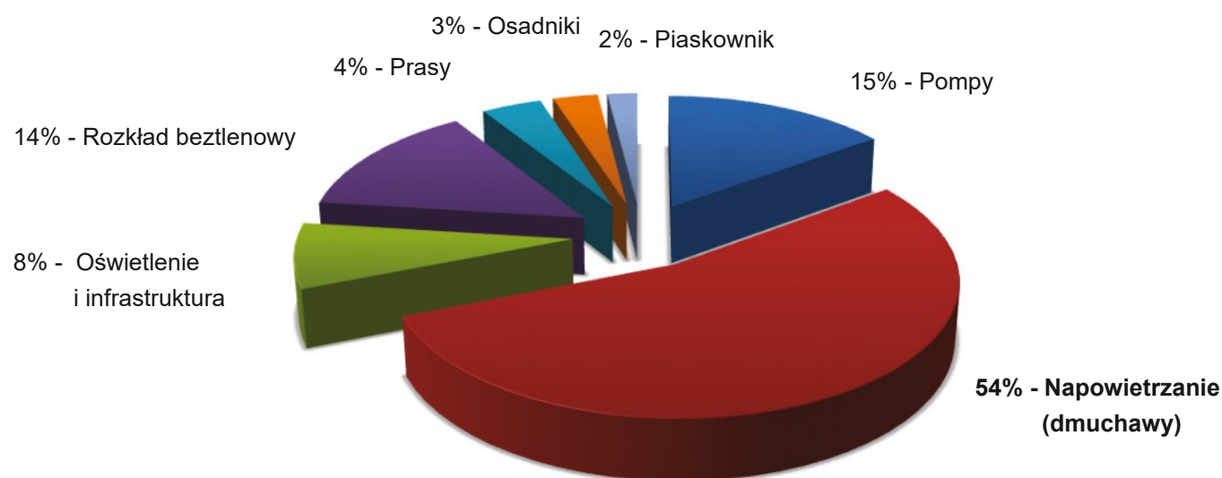
Wykres - Rozkład zużycia energii elektrycznej na typowej oczyszczalni ścieków.
